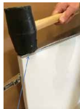
Bruk gummiklubbe eller hammer m/trekloss og bank forsiktig grepet på plass.
